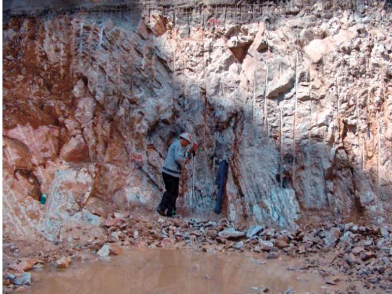
Fig. 21 Ekzaminimi i detajuar i çarjeve për ndërtimin e pendës të Kozjakut
